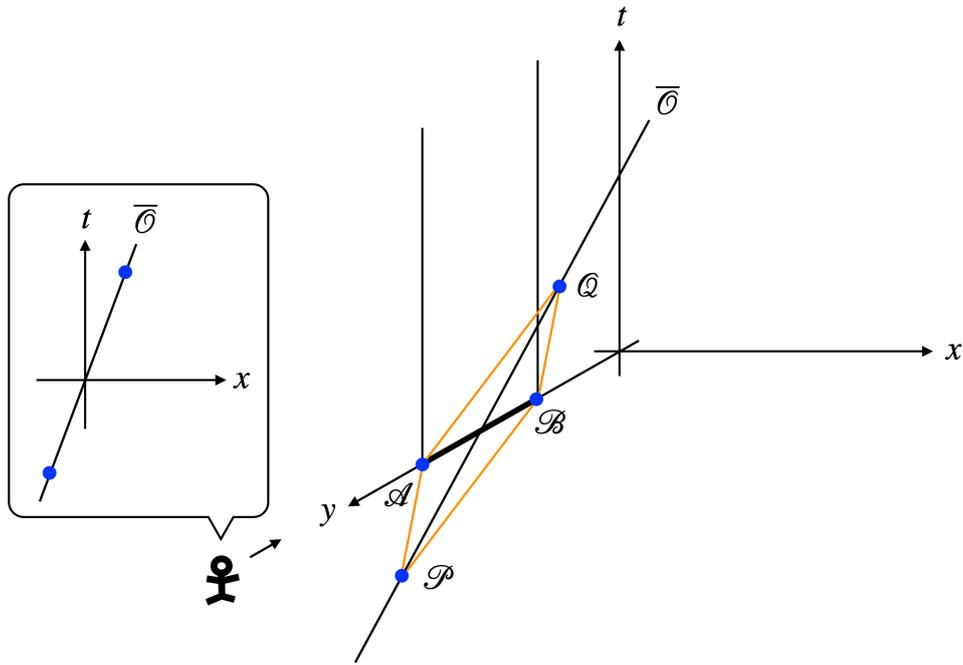
図 7:  $\bar{\mathcal{O}}$  の  $\mathcal{O}$  に対する速度  $v$  と直交する方向に取られた棒と、その端点の世界線。事象  $\mathcal{A}, \mathcal{B}$  は  $\bar{\mathcal{O}}$  にとって同時であり、かつ  $\bar{\mathcal{O}}$  にとっても同時である。
