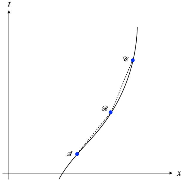
図 24: 四元加速度の計算手続き。事象  $\mathcal{A}$   $\mathcal{B}$  間で四元速度を求め、同様に事象  $\mathcal{B}$   $\mathcal{C}$  間で四元速度を求めた後、その四元速度の差を  $\mathcal{A}$   $\mathcal{B}$  の中点と  $\mathcal{B}$   $\mathcal{C}$  の中点の間の固有時間で割った量を考える。事象  $\mathcal{A}$ ,  $\mathcal{B}$ ,  $\mathcal{C}$  を限りなく近づけたとき、この量が事象  $\mathcal{B}$  における 2 階微分  $d^2\vec{x}/d\tau^2$  である。
